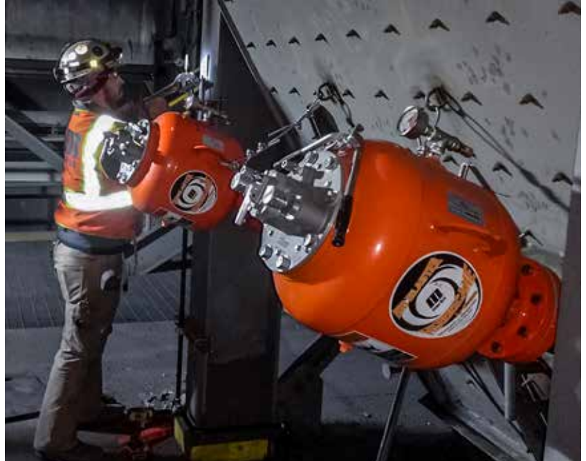
Tek bir çalışan, dışa bakan valflerde bakım gerçekleştirerek potansiyel riski azaltır.
