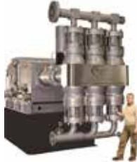
Resim-2: Feluwa Hortum-Diyafram Pompa 230 m³/h debi ve 50 bar basınç altında çalışan pompa - Verim %97
